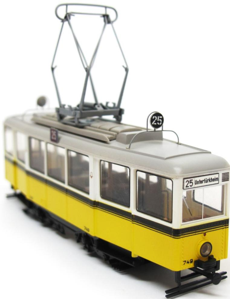
Der KSW oder Kriegsstraßenbahnwagen wurde als Ersatz für die im 2. Weltkrieg zerstörten Wagen konzipiert: materialsparende Leichtbauweise, einfach in der Wartung, und mit vielen Stehplätzen und dadurch hoher Fahrgastzahl. Ca. 700 der größtenteils hölzernen Wagen wurden zwischen 1943 und 1950 in über 20 Städte, darunter Stuttgart, München und Köln, geliefert.
