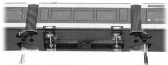
Wagenkasten an der Front/Heck mit einem Schraubenzieher oder ähnlichen Werkzeug anheben und vorsichtig wie abgebildet wegziehen. Front und Heck sind in gleicher Weise zu demontieren. Der mittlere Wagenkasten ist nur aufgesteckt und kann bei Bedarf noch oben abgezogen werden.
