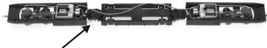
Bei angetriebenen Modellen befindet sich bei einem der Beiden Gelenken (Faltenbalg-Position) der Schnittstellenstecker für den Einbau eines Digital-Decoders.
