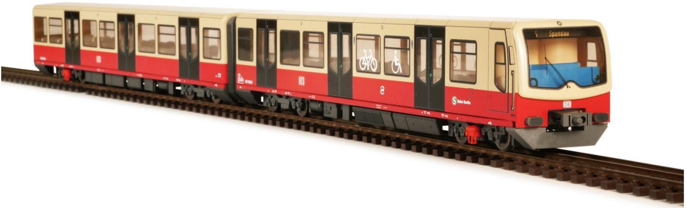
Die **Baureihe 481/482** sind elektrische Triebwagen für Stromschienenbetrieb der S-Bahn. Sie ist die meistgenutzte Baureihe der S-Bahn Berlin. 1996 wurde der erste Vorserien-Viertelzug der Öffentlichkeit vorgestellt. Ab 1996 wurden jährlich 60 der zweiteiligen Viertelzüge ausgeliefert bis 2004 der 500. Viertelzug übergeben wurde.
