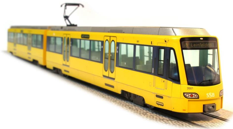
Der DT 8 ist eine Type von Stadtbahnfahrzeugen der **Stuttgarter Straßenbahnen (SSB)**. DT8 steht für Doppeltriebwagen Typ Stuttgart mit acht Achsen. Ein Stadtbahnzug besteht aus zwei kurzgekuppelten Triebwagen mit acht Achsen. Die DT8 fahren auf Normalspur und haben die meterspurigen Straßenbahnen des Typs GT4 im Planbetrieb abgelöst.
