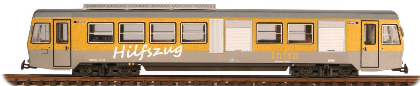
Als **Hilfszug** bezeichnet man alle selbstfahrenden oder mit Lokomotiven bespannten Eisenbahnfahrzeuge, die bei Eisenbahnbetriebsunfällen oder anderen Betriebsstörungen eingesetzt werden, um Hilfe zu leisten, zu räumen oder Unfallfolgen zu beseitigen.
