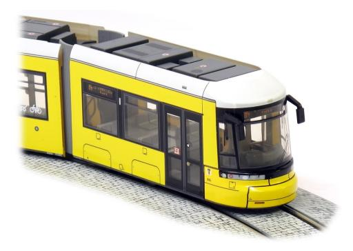
Die **Flexity Berlin** sind Niederflur-Straßenbahnwagen der Flexity-Reihe von Alstom (Bombardier Transportation). Sie sind eine Weiterentwicklung basierend auf dem Adtranz Incentro. Ein Wagen setzt sich aus Modulen zusammen, die Normalversion besteht aus fünf, die Langversion aus sieben Modulen. Ein Teil der Züge ist mit einer neu entwickelten Laufflächenkonditionierung ausgerüstet. Dieses fahrzeugbasierte Schmieranlagensystem soll die Fahrgeräusche insbesondere in engen Gleisbögen reduzieren.
